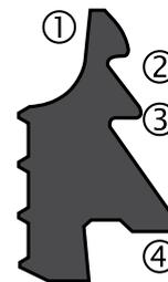
1. Spannschneide – sie verhindert die Eindringung der Verschmutzung zwischen die Dichtung und die Rohrwand;
