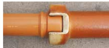
Dies wird mittels einer Übergangsmuffe vom PVC zum Steingut (KGUSM) durchgeführt, die in den Stutzen eines mit einer abdichtenden Gummimanschette versehenen Steingutrohrs hineingeschoben wird. Wenn das Steingut nicht mit einer Dichtung versehen ist, ist das klassische Stemmen, gegebenenfalls Polyurethanbindemittel, zu wählen.
